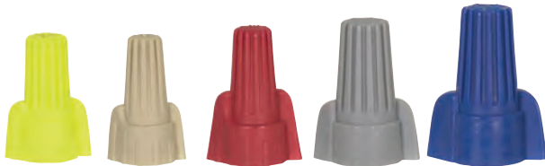
90-2237 Yellow (105°C) 4 # 18 Max. 90-2238 Tan (105°C) 9 # 18 Max. 90-2239 Red (105°C) 5 # 16 Max. 90-2240 Grey (105°C) 4 # 12 Max. 90-2241 Blue (105°C) 4 # 10 Max.
